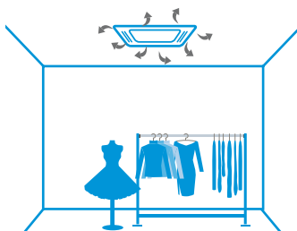
Distribuzione dell'aria con filtro sporco
